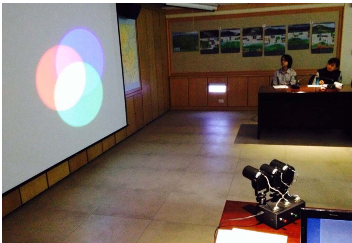
圖一：製作完成之色光混色儀及其展示使用情形
