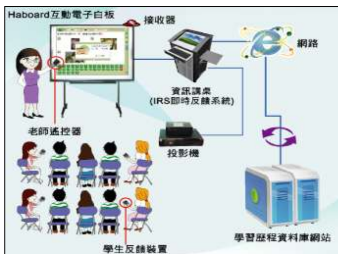
圖一、即時反饋系統運作方式圖 (圖片來源: 網奕資訊)
