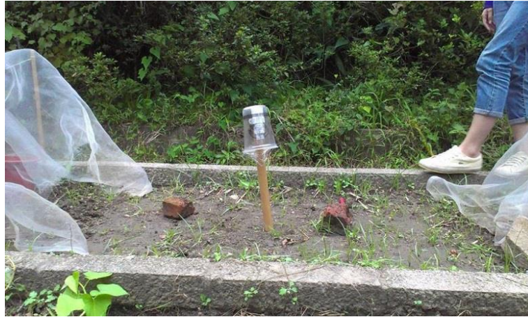
圖13-2. 未栽植區自記式溫溼度感測器架設(課程第六週)
